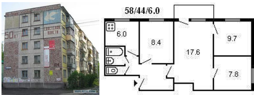
OBR. 19.1-1. DŮM ZE SÉRIE 1-335A-2 A PLÁNEK JEHO ČTYŘPOKOJOVÉHO BYTU. TENTO BYT BYL UMÍSTĚN SVOU DELŠÍ VNĚJŠÍ STRANOU NA PŘEDNÍ PODÉLNĚ STRANĚ BUDOVOU Z OPAČNĚ STRANY, NEŽ BYL VCHOD.
